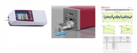
Hình 5.7 Hệ thống đo độ nhám bề mặt MITUTOYO SJ-210 178-390
