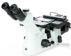
Hình 5.8 Kính hiển vi Oxion Inverso materials science
